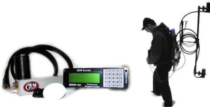
Figura: magnetometro Gem 35
