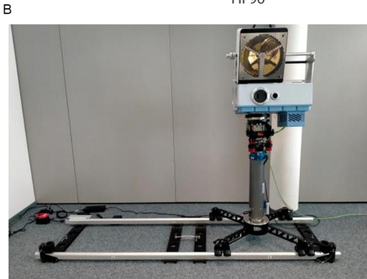
Disegno schematico della configurazione di misurazione. La sorgente luminosa esterna è integrata sulla parte superiore dell'interferometro e l'intero sistema è installato su binari, carrello e sistema di sollevamento per un facile spostamento e movimentazione orizzontale e verticale.
