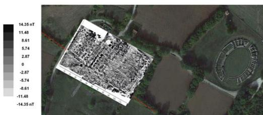
Figura: sistema gradiometro fluxgate con esempio di risultato.
